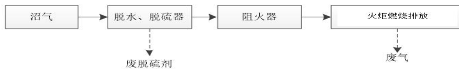
图 3.4-4 沼气处理及利用工艺流程及产污图
